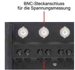
M3-Schraubklemmen für die Temperaturmessung ‡ Für jeden Kanal steht ein BNC-Steckanschluss und ein M3-Schraubklemmenanschluss zur Verfügung.
