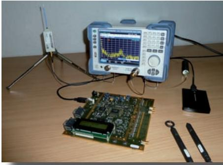
Prinzipieller Messaufbau mit HZ551 und Spektrumanalysator
