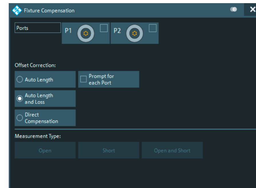
Das Menü Prüfadapterkompensation gibt einen guten Überblick über alle verfügbaren Kompensationsverfahren.
