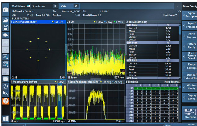
Demodulation eines Bluetooth®-Signals mit der Option R&S®FPL1-K70
