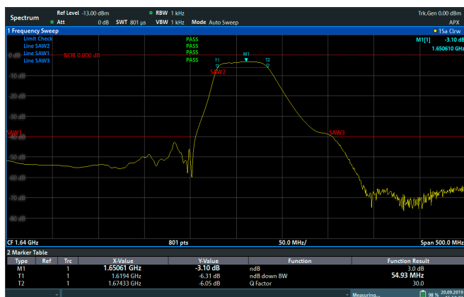
Messung und Qualifizierung eines SAW-Filters (n-dB-Down-Bandbreite, Gütefaktor)
