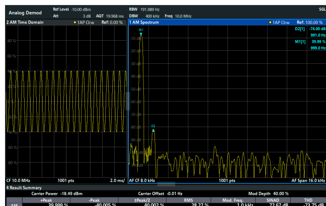
Klirrfaktormessung an einem amplitudenmodulierten Signal: Die erste Oberwelle des Modulationssignals ist mit 74 dB gut unterdrückt
