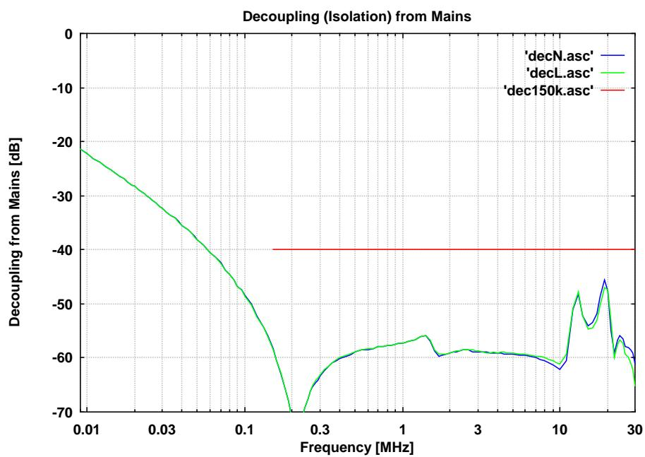
Abb. 7: Entkopplung vom Speisenetz, BNC mit 50 Ω Abschluss
