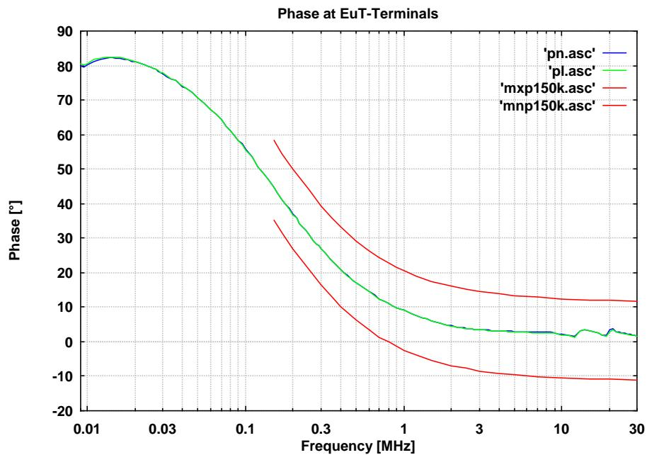
Abb. 6 Phase an den Prüflingsklemmen, BNC mit 50 Ω Abschluss
