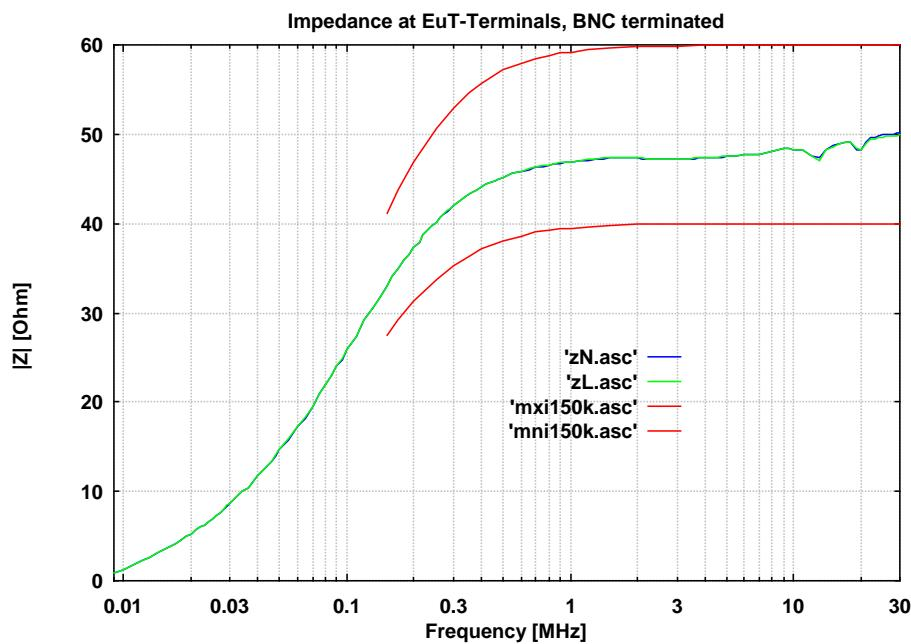
Abb. 5: Impedanz an den Prüflingsklemmen), BNC mit 50 Ω Abschluss
