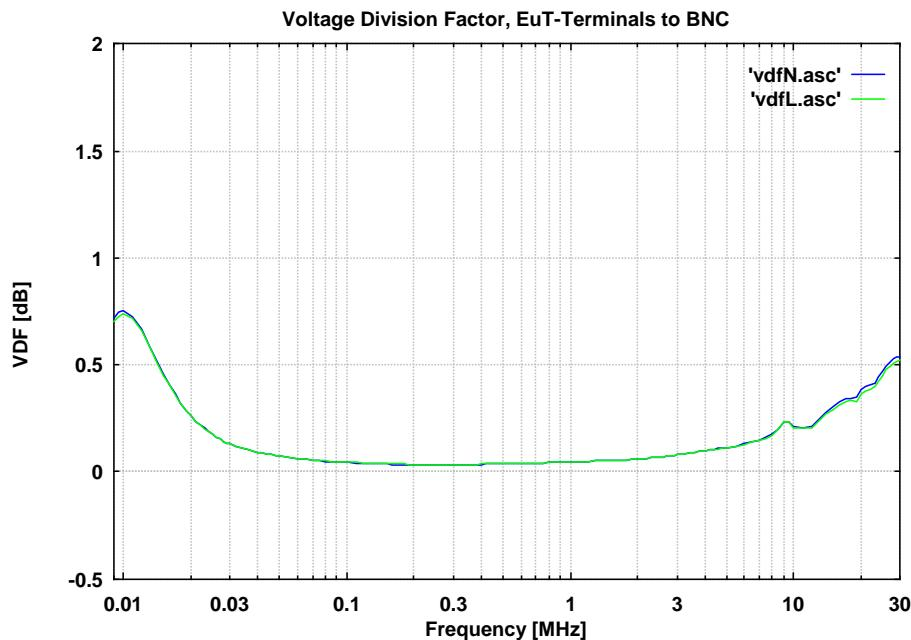
Abb. 4: Spannungsteilungsmaß, Prüflingsklemmen - BNC
