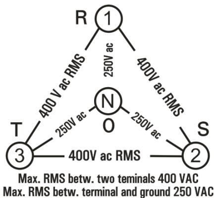
Mit der Option „400/700 V“ wird die maximale Spannung zwischen einem Pfad und Masse auf 400 V, 50/60 Hz oder 630 VDC erhöht und zwischen zwei Pfaden auf 700 V, 50/60 Hz.
