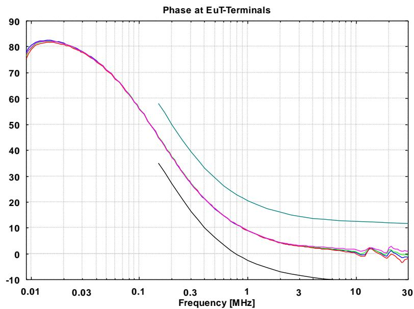
**Abb. 6 Phase an den Prüflingsklemmen, BNC mit  $50 \Omega$  Abschluss**
