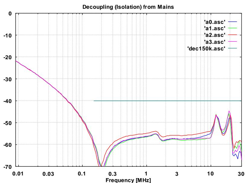
**Abb. 7: Entkopplung vom Speisenetz, BNC mit  $50 \Omega$  Abschluss**
