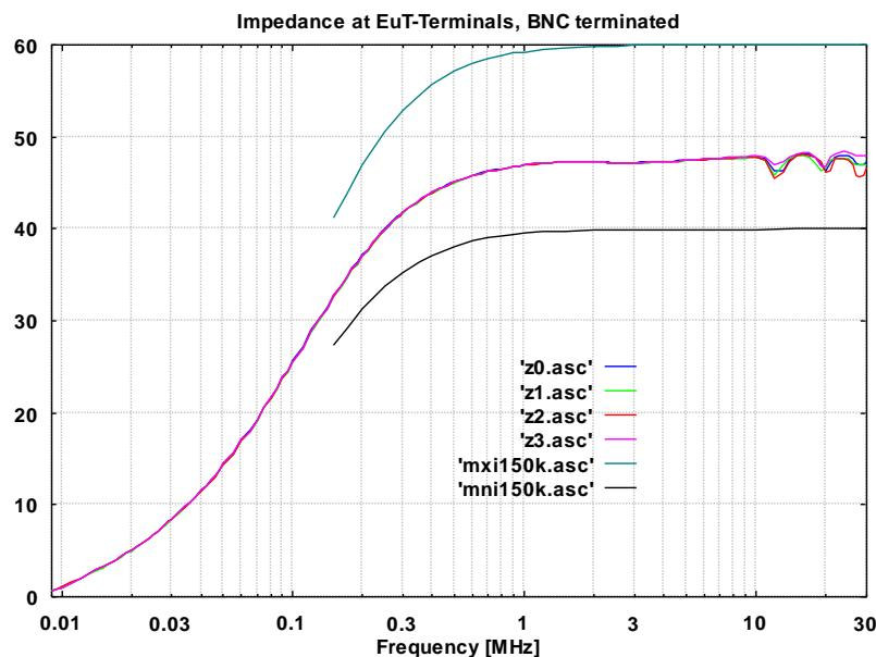
Abb. 5: Impedanz an den Prüflingsklemmen), BNC mit 50 Ω Abschluss
