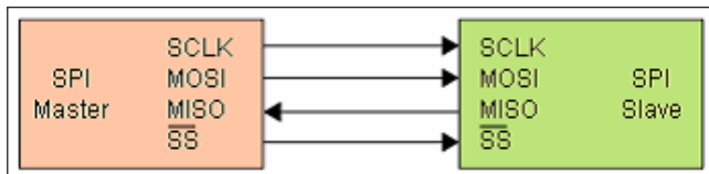
Abb. 12.9: Einfache Konfiguration eines SPI BUS
