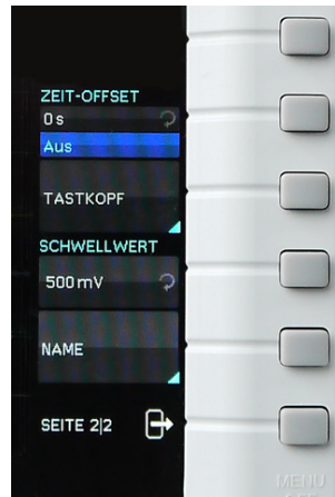
Abb. 2.6: Softmenügrundelemente Einstellung und Navigation
