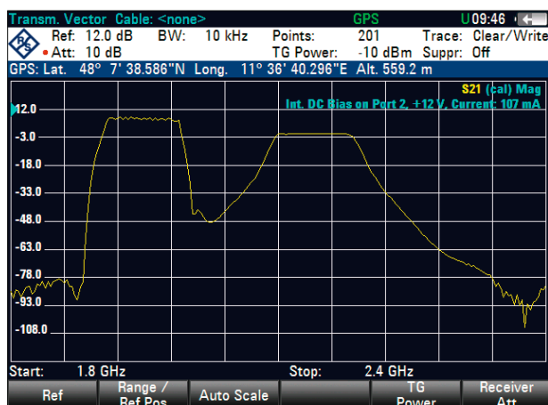
Anzeige des aktuellen Standortes bei angeschlossenem R&amp;S®HA-Z240 GPS-Empfänger während einer Transmissionsmessung.
