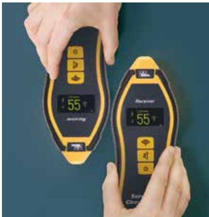
Revolutionäre Technologie beim Modell 957 und 959 lässt die Anzeige in 90°-Schritten drehen, so dass Sie immer eine direkt ablesbare Ergebnisanzeige bekommen, die nie auf dem Kopf steht.
