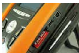
Compact Flash Kartenslot für die Speichererweiterung und USB-Stick Anschluss für die direkte Übertragung der Messdaten
