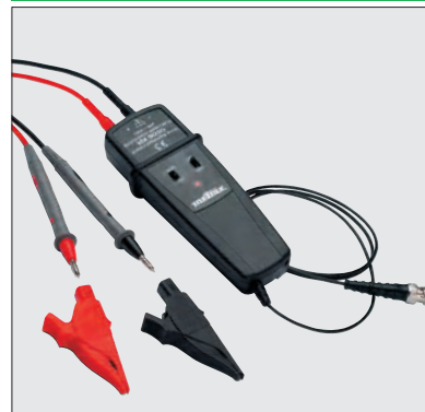
Differenzspannungssonde MX 9030 _____ MX 9030-Z gem. IEC 61010-1, CAT IV-2 Ermöglicht die Anzeige von hohen Differenzspannungen bis \pm 600 V auf einem Oszilloskop bei voller Sicherheit. Bandbreite: 30 MHz Siehe S. 161
