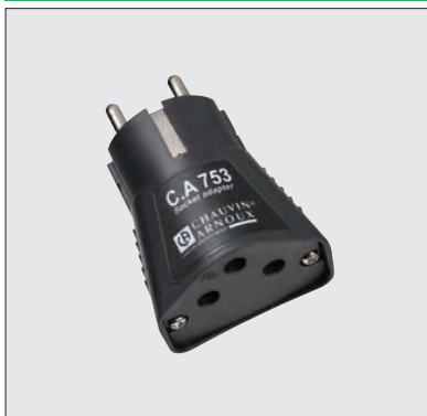
C.A 753 Adapter zur Messung an Schutzkontakt-Steckdosen _____ P01191748Z Geeignet für alle Prüfspitzen (2 und 4 mm Ø, 1P2X,...) Erkennung Außenleiter / Neutraleiter IEC 61010 230 V CAT II
