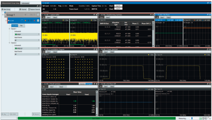
Bild 9: 5G-NR-MIMO-Analyse mit der Software R&S VSE auf Basis der Messwerte zweier R&S NRQ6
